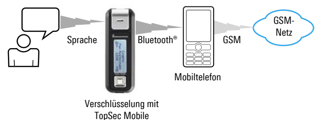
BILD 2 Mobile Kommunikation mit dem TopSec Mobile: Das Verschlüsselungsgerät arbeitet mit fast allen modernen Mobiltelefonen zusammen.
