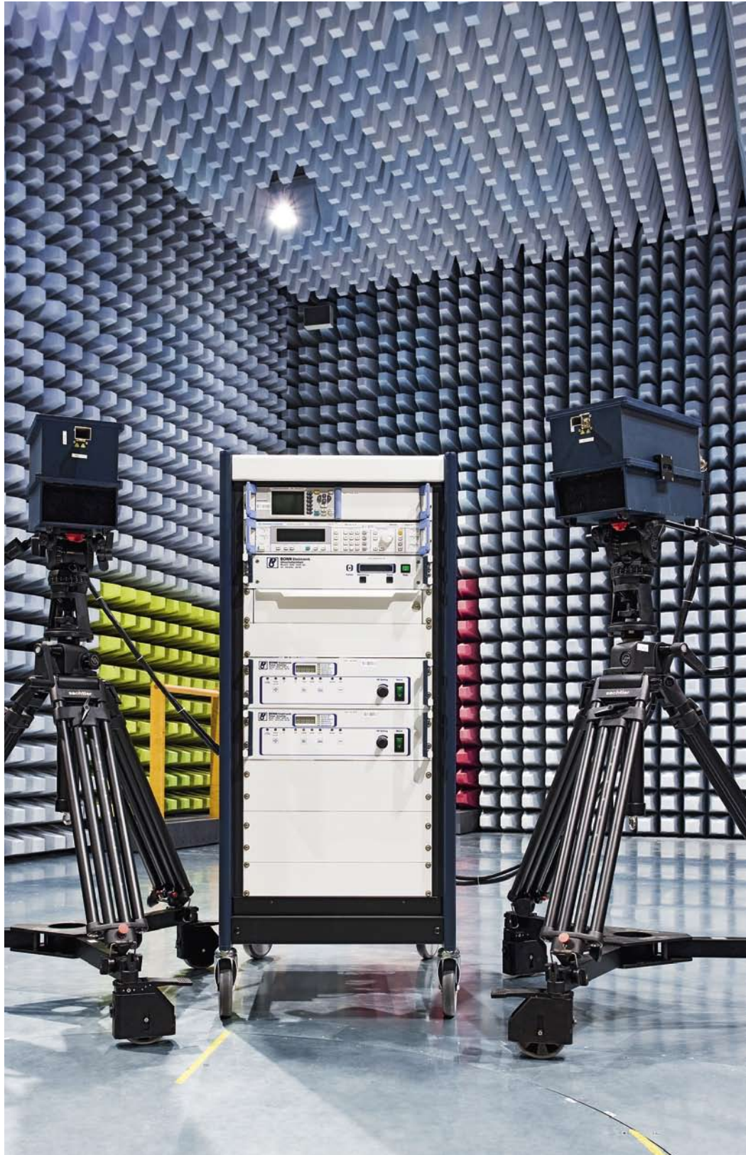
BILD 1 Von der Vorstufe abgesetzte Verstärker / Antenneneinheiten erzeugen mit 40 W Leistung bei 40 GHz im Abstand von 1 m Feldstärken zwischen 200 V/m und 300 V/m.
