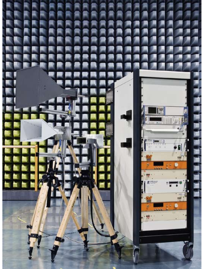
BILD 7 Mobile Testsysteme erzeugen bis 18 GHz gepulste und ungepulste Felder mit Stärken bis 600 V/m.
