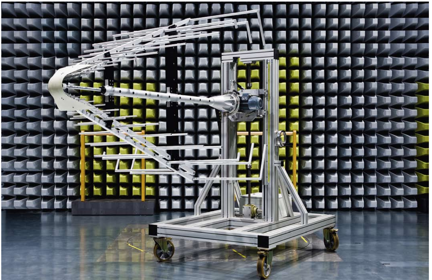
BILD 8 Kompakte LPD-Antennen erzeugen oberhalb von 80 MHz die für Tests erforderlichen gerichteten elektromagnetischen Felder.
