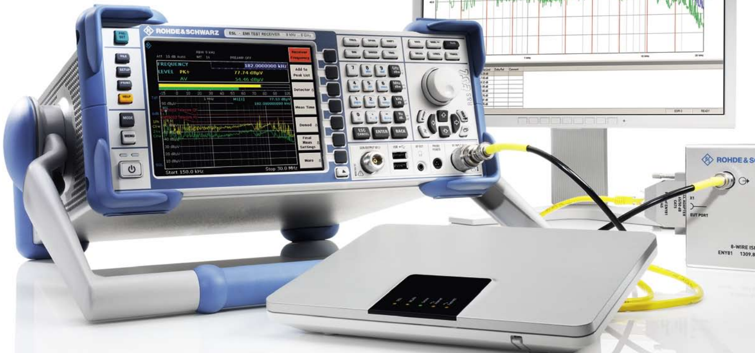
BILD 8 Diagnosemessung mit dem R&S®ESL an ungeschirmten Telekommunikations-Anschlüssen mit Achtdraht-ISN R&S®ENY81 und EMV-Messsoftware R&S®ES-SCAN.
