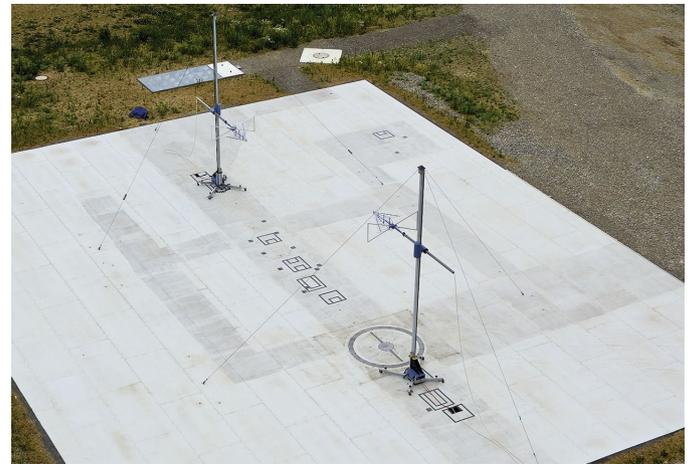
BILD 2 Der Antennen-Freifeldmessplatz (20 m x 25 m) der Rohde&Schwarz Messgerätebau GmbH in Memmingen bietet beste Voraussetzungen für hochgenaue Antennenkalibrierungen.
