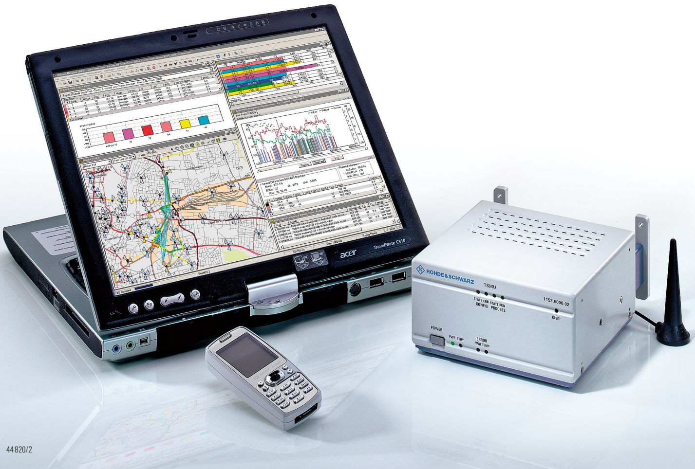
BILD 1 Der R&S®TSMU kann Gleichkanal- und Nachbarkanalinterferenzen in GSM-Netzen während einer Testfahrt automatisch erkennen, analysieren und die Ergebnisse darstellen.
